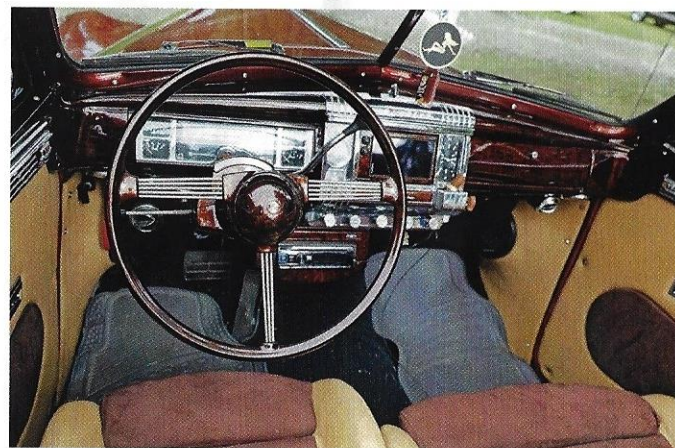
Mycket är nytt på instrumentbrädan, men tillverkat för att passa den gamla stilen. Original sitter det ett gigantiskt högtalargaller i mitten.
