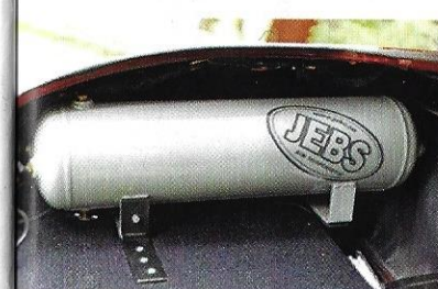
Komfortabel körning blir det tack vare luftfjädring med en rejäl tank.
